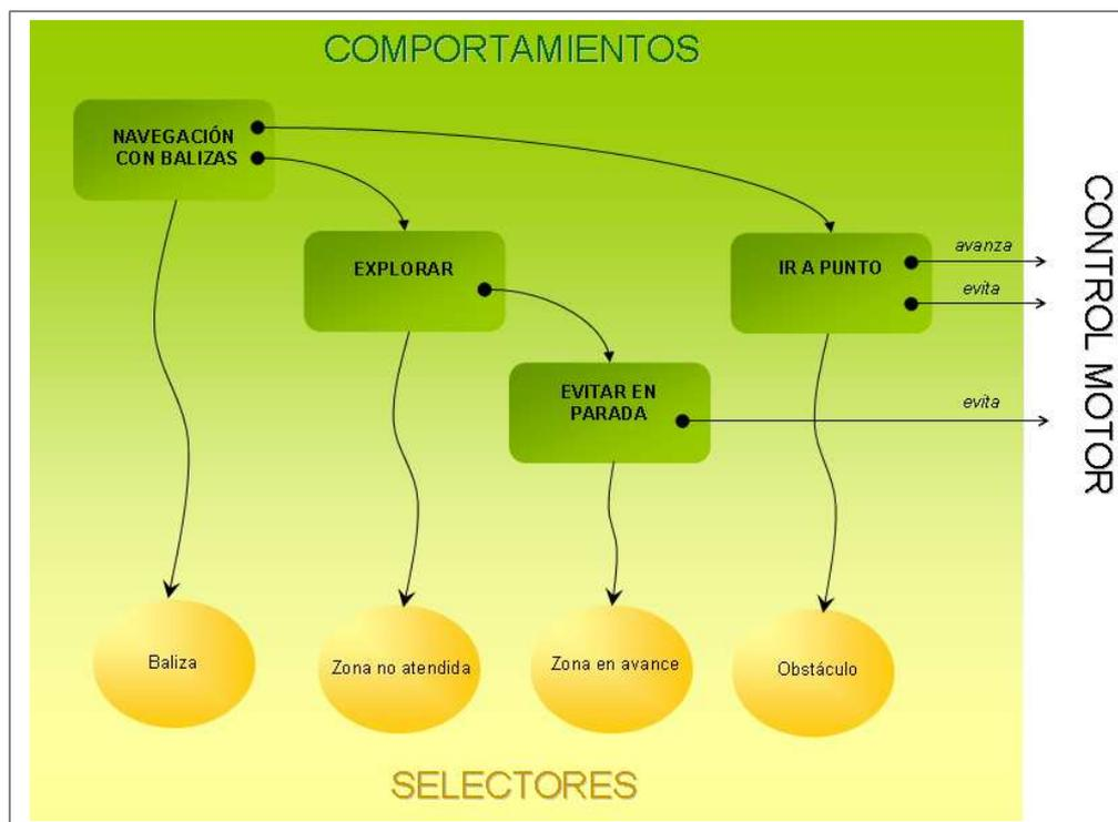
Figura 6.21: Componentes de control en una tarea de navegación con balizas
